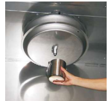
Opróżnianie tacy ociekowej filtra Turbo-Swing
